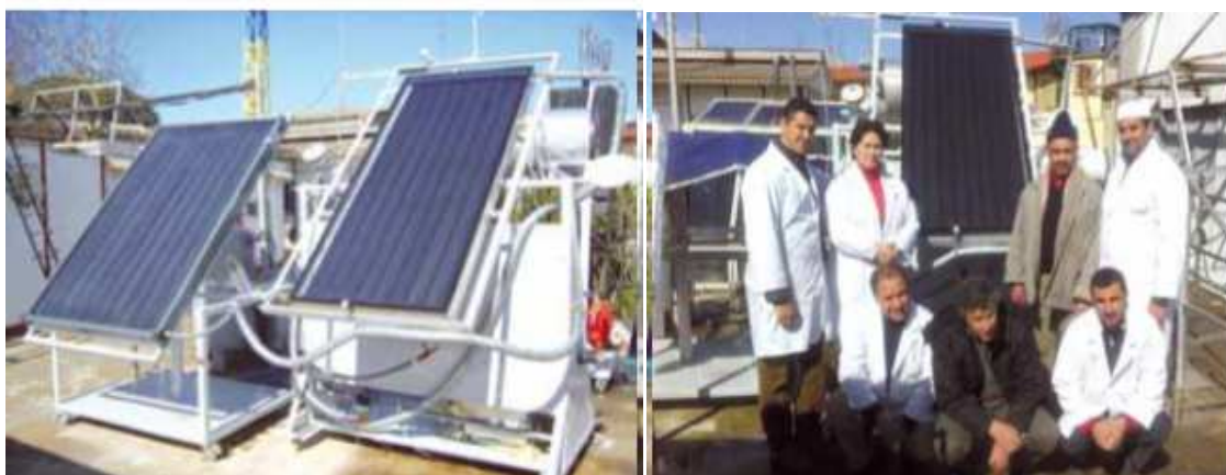
Figure (II-16) : Banc d'essais des capteurs solaires plans et chauffe-eau solaire réalisé par la division solaire thermique et géothermie
