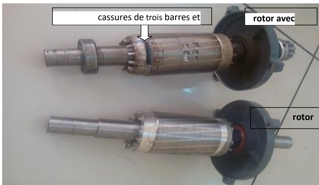
Figure II.8 Cassures de barres et de portions d'anneaux.
