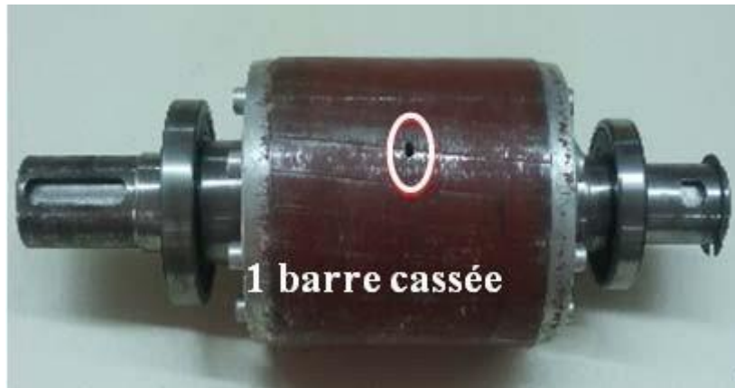
Figure III.16 Défaut d'une barre cassée .
