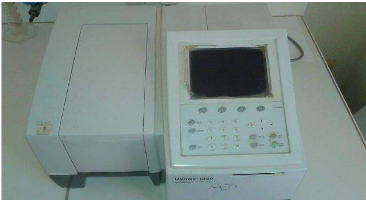
**Fig II.8** spectrophotomètre UV-Visible.
