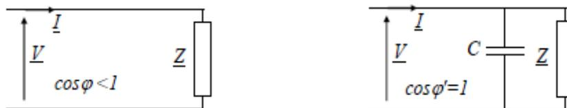
**Figure II.3 :** Principe de compensation
