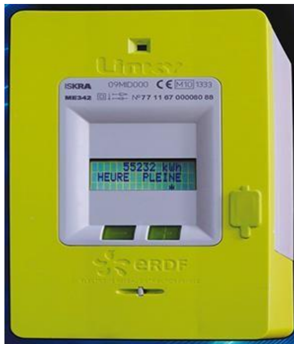
Figure (II.7) : un compteur communicant 'Linky'.
