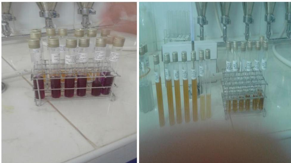
Figure N<sup>o</sup> 28. Recherche et dénombrement des coliformes en milieu liquide
