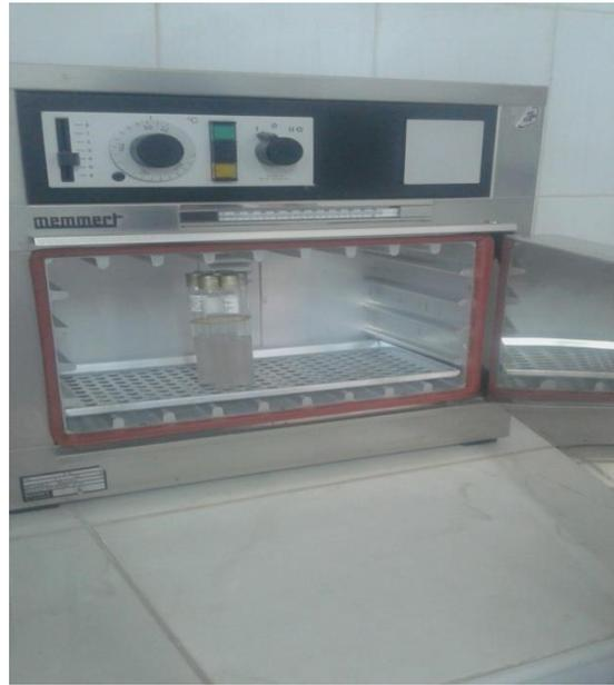
Figure N<sup>o</sup> 31. Recherche et dénombrement des streptocoques – test de présomption
