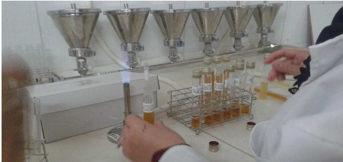
**Figure N° 29. Recherche et dénombrement des coliformes fécaux**
