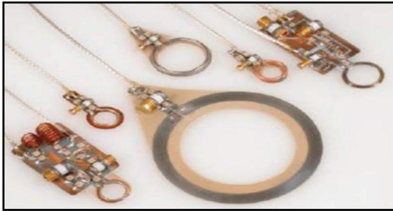
Figure I.24: Différents types d'antennes de surface.
