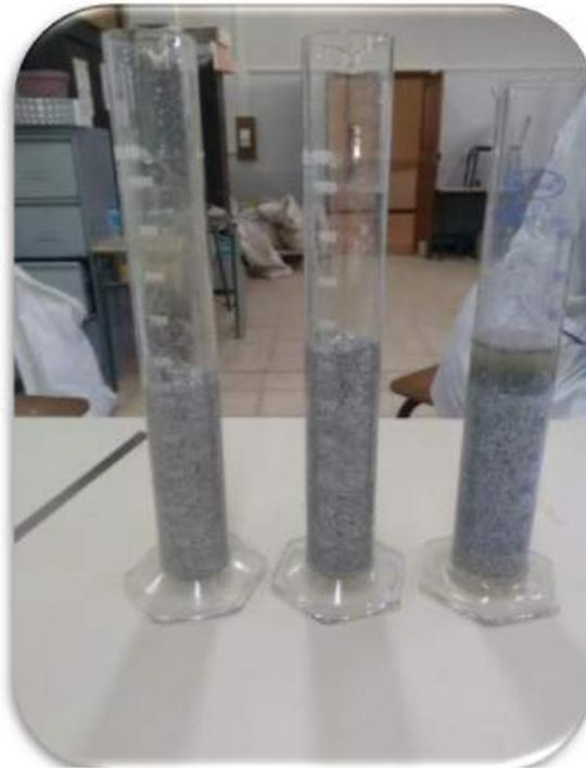
FIGURE 4.9 – mesure de la masse volumique absolue des fibres aluminium
