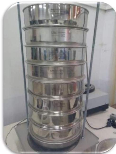
FIGURE 4.2 – Colonnes de tamis
