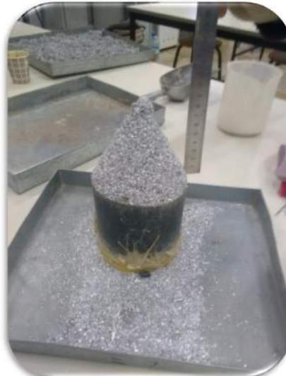
FIGURE 4.10 – mesure de la masse volumique apparente des fibres aluminium
