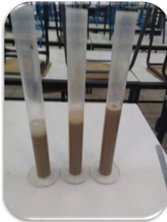
FIGURE 4.5 – Equivalent de sable
