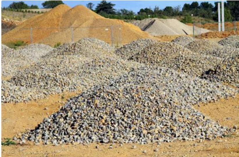
FIGURE 1.3 – les Granulats utilisé dans le béton
