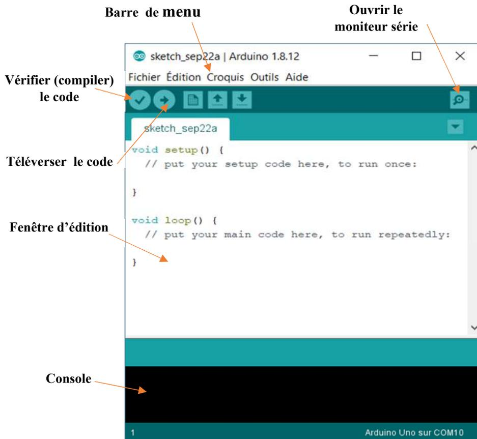
Figure 2.3 : Interface du logiciel IDE Arduino.
