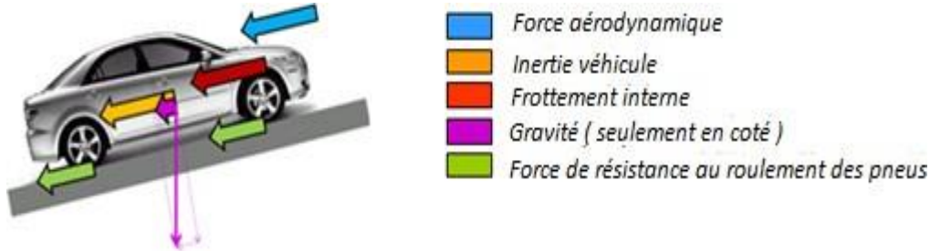
Figure. 1.6 Les forces de résistance à l'avancement de véhicule
