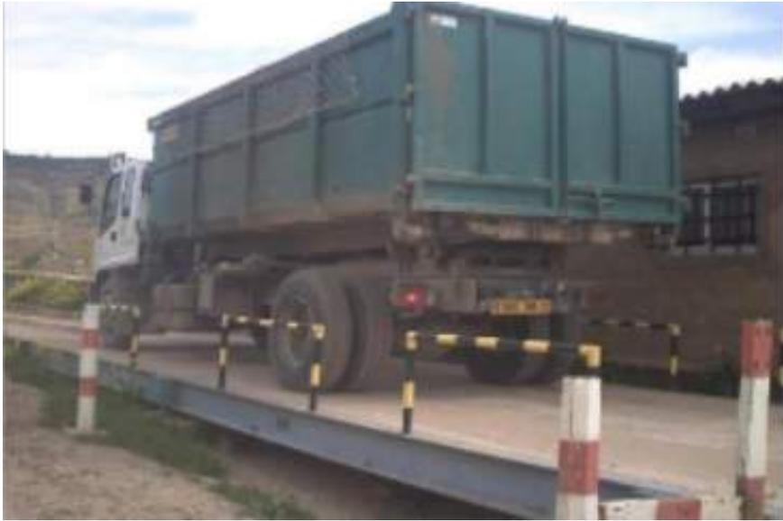
**Figure IV-11:** Pesée d'un camion sur le pont bascule
