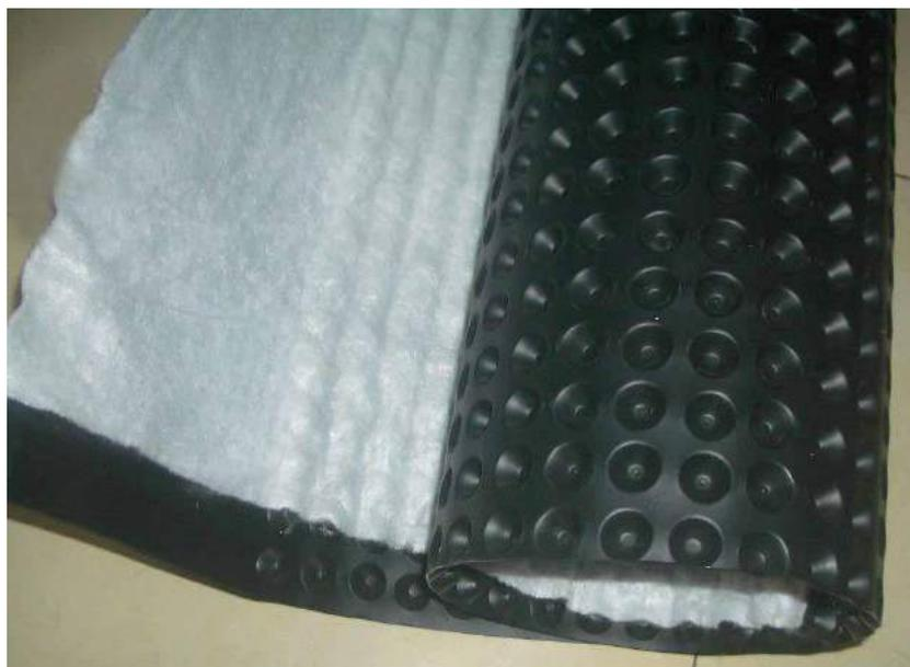
**Figure III-4:** Fossette de drainage en PEHD avec géotextile.
