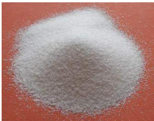
**Figure 27 : Grains abrasifs "Corindon Supérieur Blanc".**
