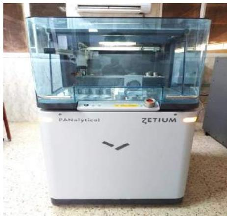
**Figure 04 : Spectromètre de Fluorescence des Rayons X (XRF)
