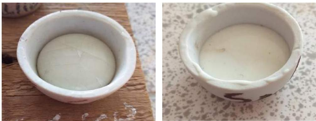
**fritté S<sub>2</sub>****Echantillon standard S<sub>2</sub>****Figure 33 : Comportement au frittage (essai creuset) des frittés S<sub>1</sub> et S<sub>2</sub>.**
