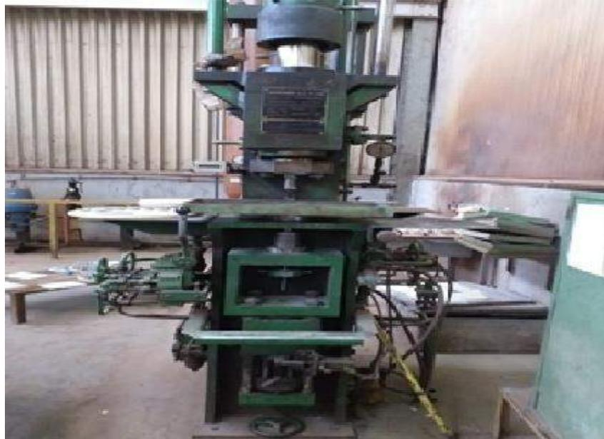
**Figure 22 : Presse hydraulique de type J.oberhammervorm.TH.Lang.**
