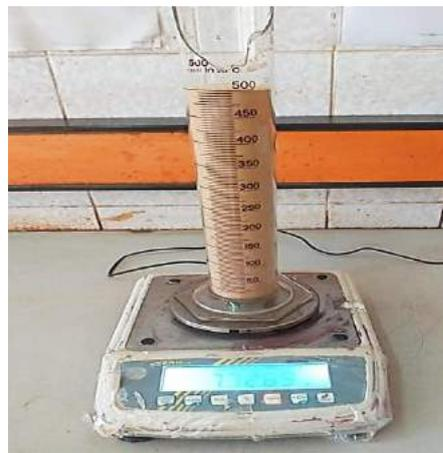
Eprouvette avec échantillon de masse  $m_2$
