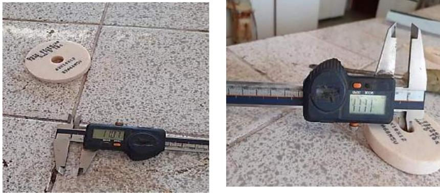
**Figure 23 : Test Aspect visuel, contrôle de la spécification et les dimensions de la meule.**
