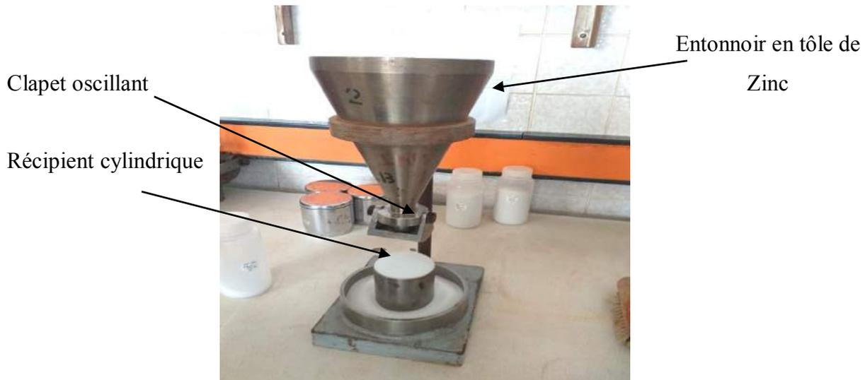
**Figure 09 : Dispositif de détermination de la densité apparente des grains abrasifs.**
