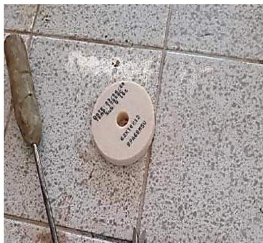
**Figure 24 : Test sonore sur la meule abrasive.**
