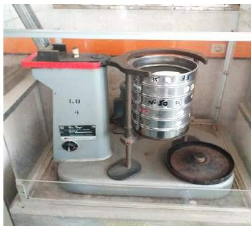
**Figure 07 : Tamiseur de type Testing Sieve Shaker.**
