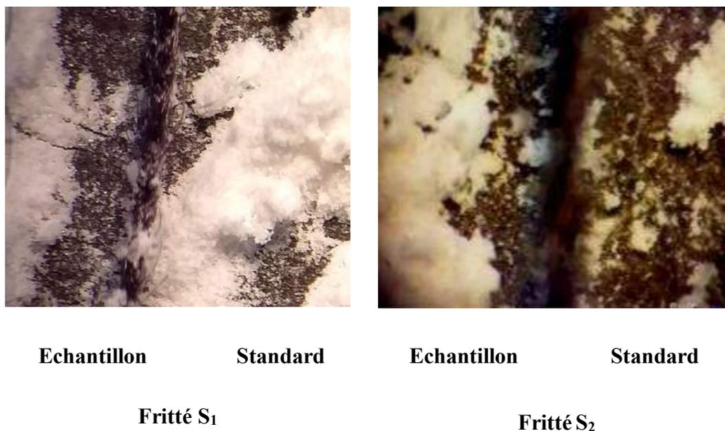
**Figure 32** : Analyse par stéréo microscope des frittés  $S_1$  et  $S_2$ .
