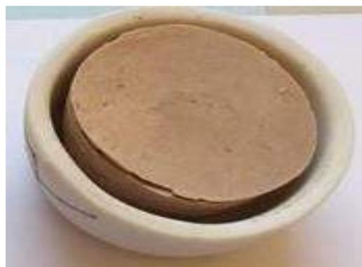
**Echantillon standard S<sub>22</sub>****Figure 37 : Comportement au frittage (essai creuset) des Feldspaths S<sub>20</sub> et S<sub>22</sub>.****III.4.2.7. Comportement de fusion (essai bouchon) des Feldspaths S<sub>20</sub> et S<sub>22</sub> :**
