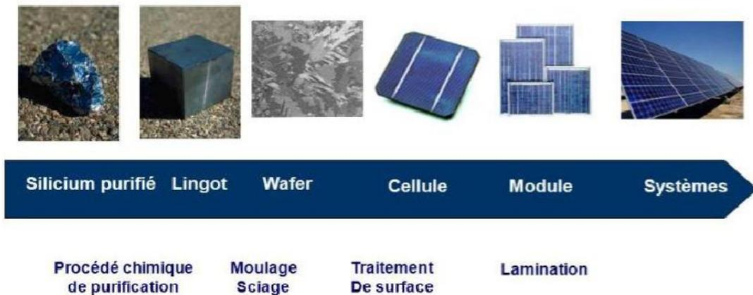
**Figure 1.9** : Etapes de fabrication de la cellule photovoltaïque
