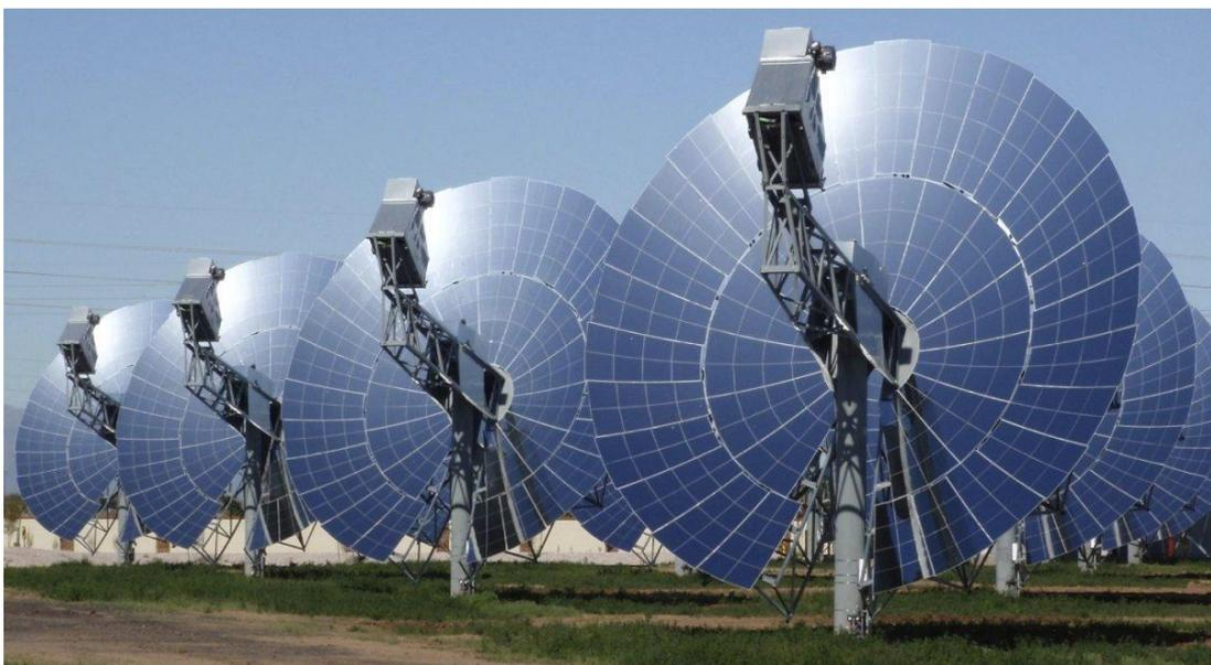
**Figure 1.6** : Photo de concentrateurs solaires paraboliques
