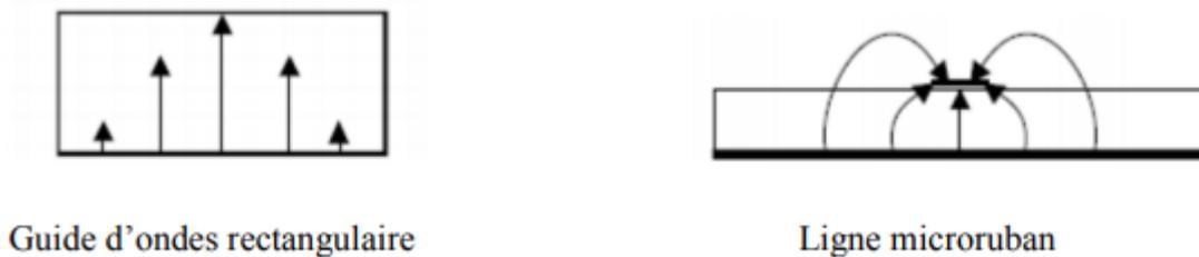
**Figure II.7:** Lignes de champs dans un guide d'ondes rectangulaire et dans une ligne microruban.
