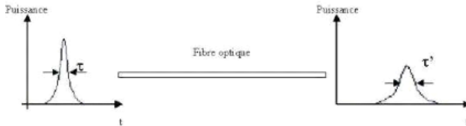
Figure I.11 : Propagation d'une impulsion le long d'une fibre réelle
