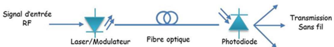
Figure II.1 : Schéma synoptique d'une liaison RoF.
