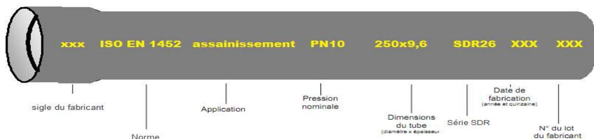
Figure I.10 : Exemple de marquage des tubes PVC compact.
