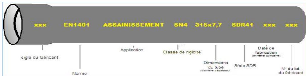
*Figure I.11 : Exemple de marquage de tubes PVC compact pour assainissement gravitaire (NA 18618).*
