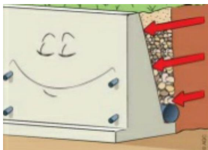
Figure 1.13 Système de drainage [9]
