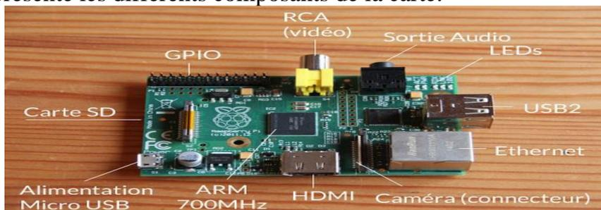
*Figure III.4:* Emplacement des ports et interfaces matérielles du Raspberry Pi.
