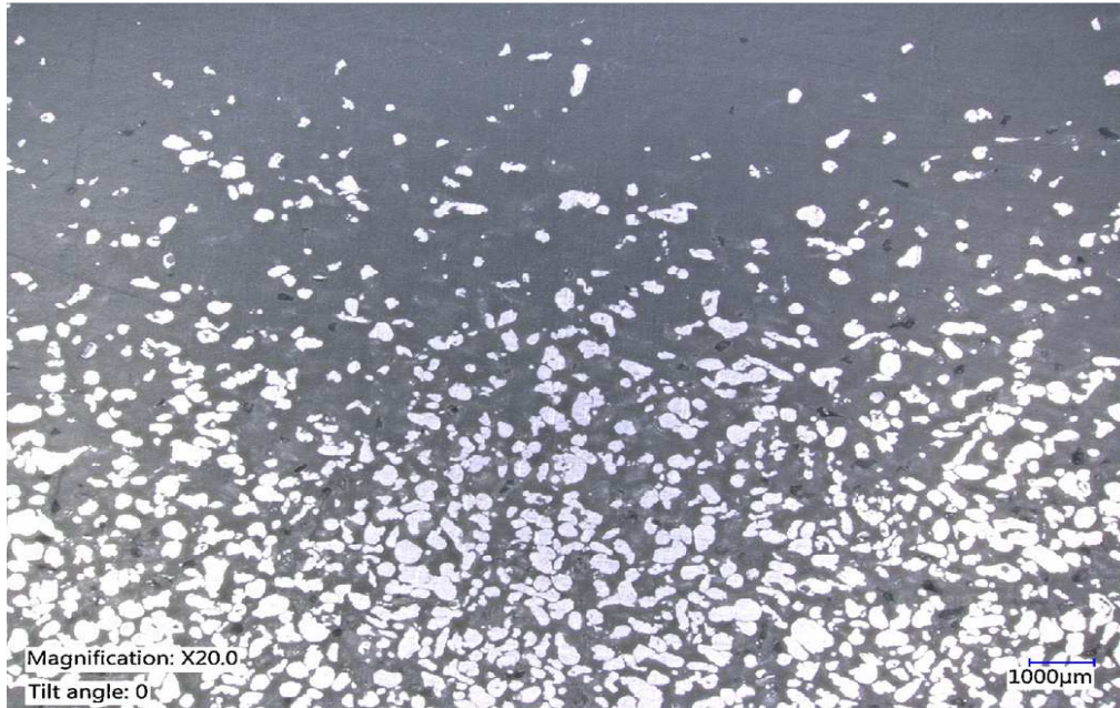
Figure II.5: Microstructure du panneau FGM contenant des particules d'aluminium dispersées dans la matrice HDPE, la concentration changeant dans le sens de l'épaisseur [43,46].
