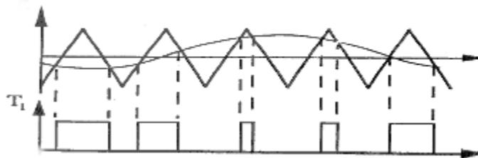
Figure II.9. Comparaisons de la modulatrice avec un signal triangulaire
