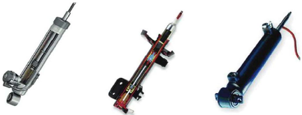
Figure I-11: Exemples d'amortisseurs semi-actifs électrovanne électro-hydraulique (Sachs), amortisseur magnétorhéologique (Delphi) et amortisseur électrorhéologique (Fludicon)
