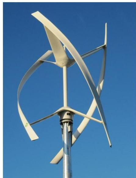
Figure (I.8): Eolienne à Axe Vertical
