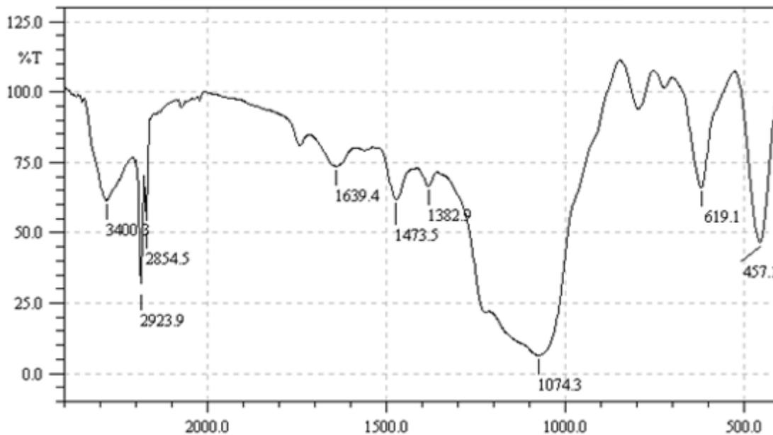
**Fig.IV.9** : Spectre IR du nanomatériau MCM-41 non-calciné synthétisé par brique.
