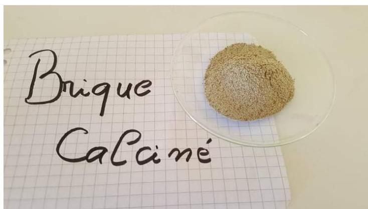
**Fig.IV.1 :** Représentation de La brique usagé utilisé dans la synthèse du MCM-41
