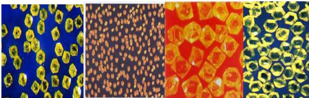
**Figure I.1.**Quelques types de grains abrasifs en diamant synthétique [9].
