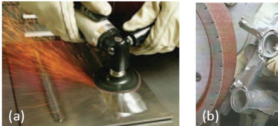
Figure III.4. Operations de reprise de forme-(a) arasage de soudure, (b) ébarbage (source 3M, PFERD)
