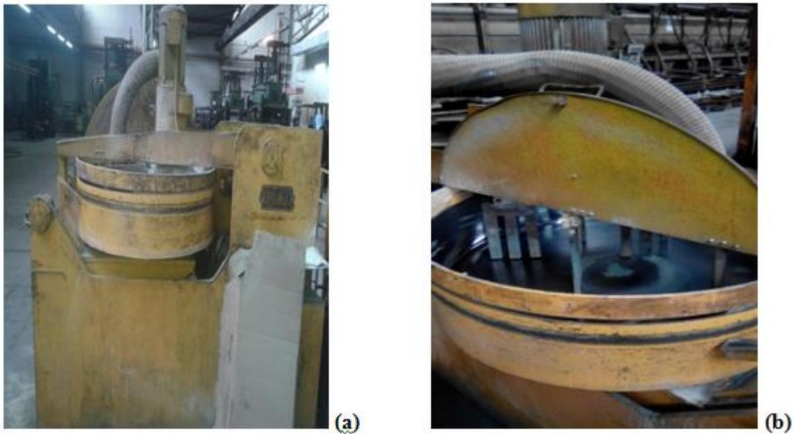
**Figure II. 7 :** mélangeur discontinu (Mélange bakélite) (a),
